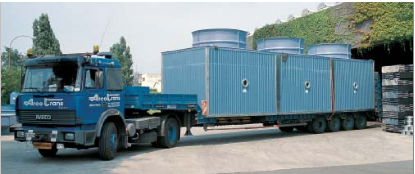
Spedizione di tre celle da kW 6490 (1116 mc/h d'acqua) su un solo autocarro senza scorta. Shipment of three cells for kW 6490 (1116 mc/h of water) on a lorry without escort.
